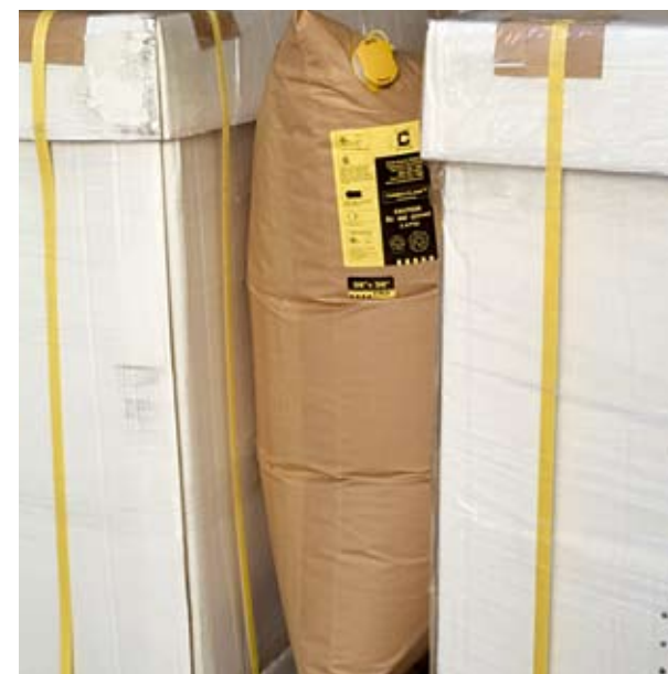
Worki sztauerskie zabezpieczą kartony z towarami, na przykład oknami, przed niepożądanym przemieszczaniem się.
